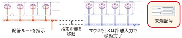
シンボルの移動とリンクし、自動で寸法線・寸法値が変更されます。
