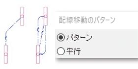
指定のシンボルを指示するだけで、配線振分を行えます。
